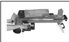
Cette fendeuse de bûches est équipée d'un système de contrôle « ZHB » qui nécessite que l'opérateur utilise les deux mains – la main gauche actionne le levier de commande hydraulique, tandis que la main droite actionne
